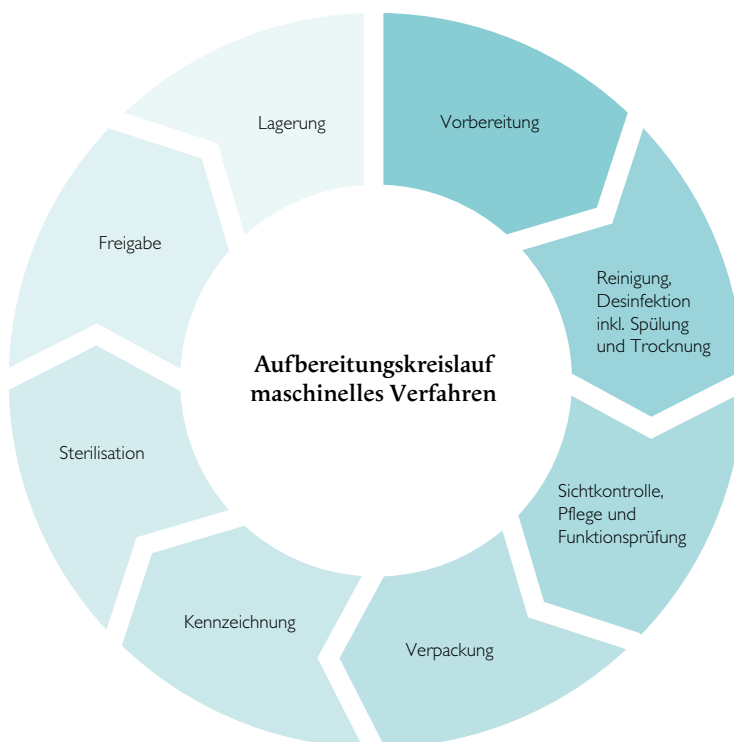
Abbildung 4: Aufbereitungskreislauf maschinelles Verfahren
